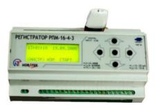
Устройство представляет собой 16-канальную систему сбора и хранения данных с архивированием их на внешнем носителе (USB-Flash диск).
