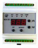
МСК-301-8 предназначен для управления морозильными камерами, холодильными прилавками, моноблоками и другим холодильным торговым и промышленным оборудованием.
