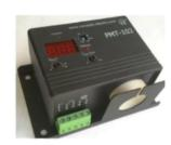
Реле РМТ-102 предназначено для постоянного контроля действующего значения тока однофазной нагрузки от 1 до 400 A и её отключения с заданным временем при превышении допустимого тока (МТЗ с независимой выдержкой времени) с последующим автоматическим включением с заданным временем включения или с блокировкой повторного включения. Измерение происходит без разрыва электрической цепи с помощью токового датчика, встроенного внутри прибора (внутренний Ø датчика 22 мм).
