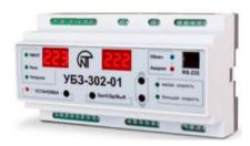
Предназначен для защиты двухскоростных (двухобмоточных) двигателей, постоянного контроля параметров сетевого напряжения, действующих значений фазных/линейных токов и проверки значения сопротивления изоляции электродвигателей. УБЗ обеспечивает защиту электродвигателей, номинальным током от 5 до 50А при использовании внешних токовых трансформаторов (три фазных и один дифференциальный), поставляемых в комплекте с изделием.
